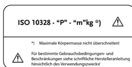
Die obengenannte Norm sieht vor, dass die Prüfungsstufen (P) einer maximalen Körpermasse (m in kg) zugeordnet werden. In einigen Fällen, die markiert sind, wird kein Prüfungsgrad der maximalen Körpermasse für das Produkt zugeordnet. In diesen
