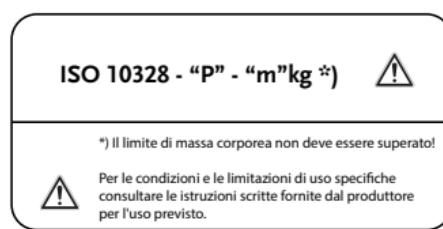
Nella norma menzionata, i livelli di prova (P) sono assegnati a determinate masse corporee massime (m in kg). In alcuni casi, i quali sono contrassegnati, nessun livello di prova è assegnato al prodotto sulla base della massa corporea massima.
