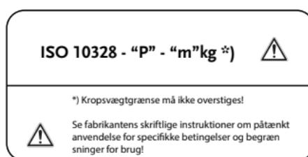
I ovennævnte standard er testniveauer (P) tildelt en bestemt maksimal kropsvægt (m i kg). I visse tilfælde, som er markeret med, intet testniveau er tildelt den produkt-relatedede maksimale kropsvægt. I disse tilfælde er testbelastingerne
