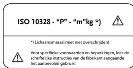
In de genoemde norm, worden testniveaus (P) toegewezen aan een bepaalde gevallen maximale lichaamsmassa (m kg). In sommige, die zijn gemarkerd met, zonder testniveau wordt toegewezen aan het product gerelateerd maximale
