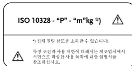
앞서 언급된 표준에서, 시험 레벨 (P) 은 최대 신체 질량 (kg에서 m)으로 배정되었습니다. 경우에 따라서, 테스트 레벨이 최대 신체 질량과 관련된 제품에 배정되지 않은 것으로 표시되어 있습니다. 이러한 경우, 테스트 하중이 지정된 하중 레벨에 기초하여 적절하게 적용되었습니다.
